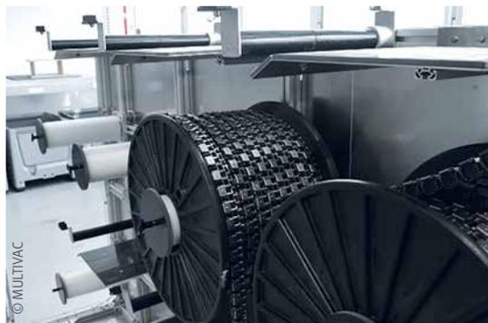
Neue Kettenablängmaschine von MULTIVAC
