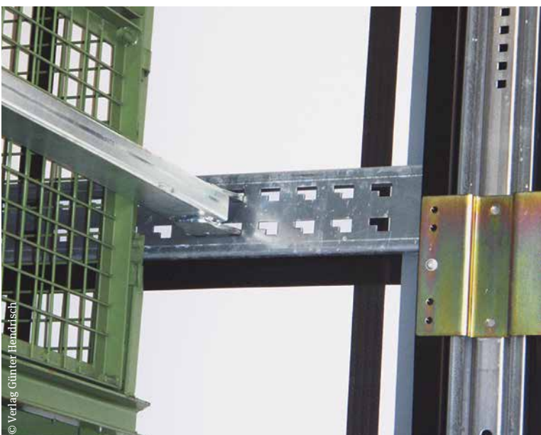
Formschlüssige Ladungssicherung mit Sperrbalken
