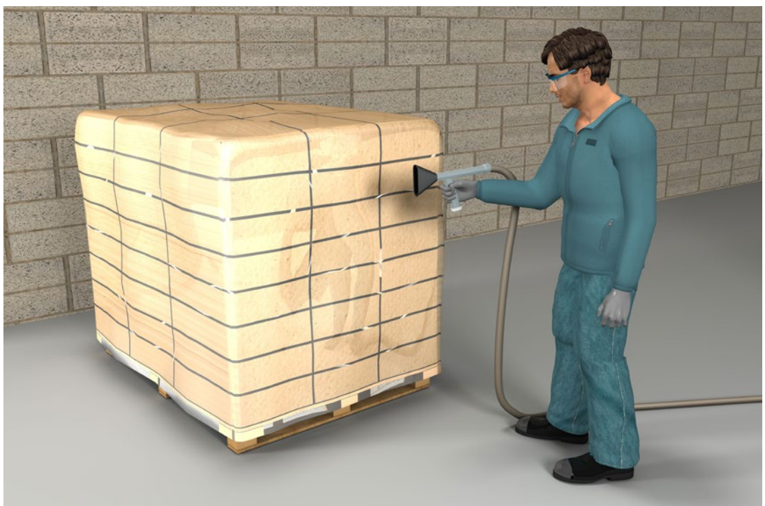
Abb.36 Schrumpfen mittels Handschrumpfgerät
