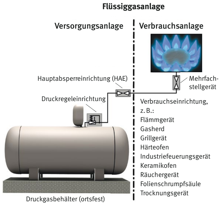
Abb. 4 Flüssiggasanlage mit Versorgung aus ortsfestem Druckgasbehälter (Flüssiggasbehälter) (Druckregleinrichtung als Bestandteil der Versorgungsanlage, Verzicht auf Darstellung des Behälterabsperrentils)
