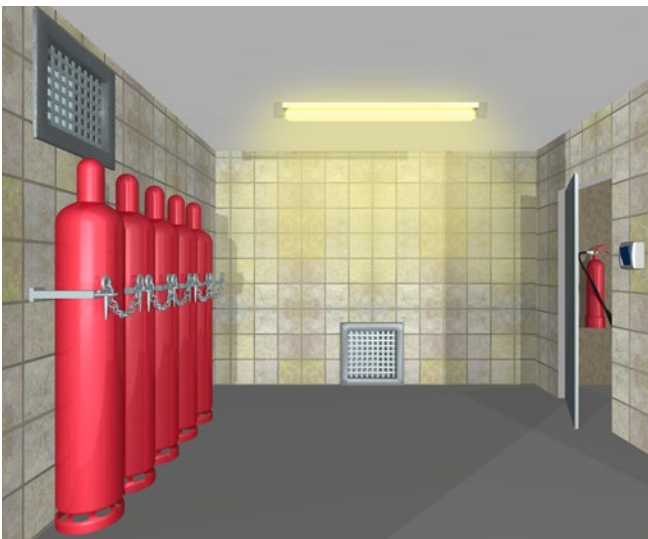
Abb. 34 Lagerung von Flüssiggasflaschen im Lagerraum
