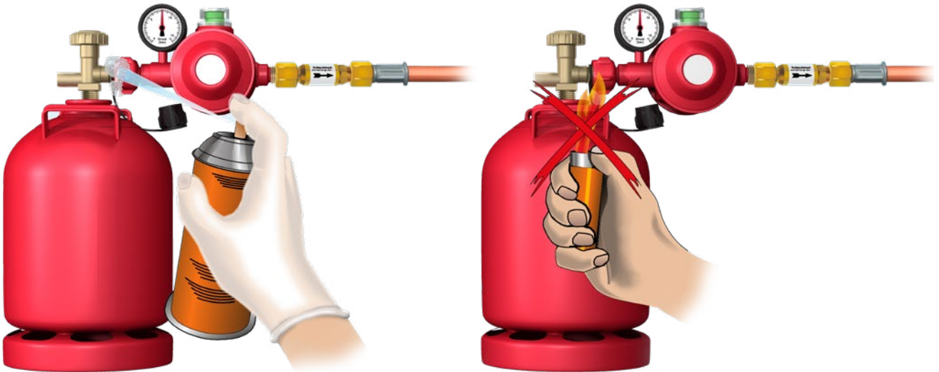
Abb. 29 Dichtheitskontrolle mittels Lecksuchspray nach Anschluss der Druckregleinrichtung an die Flüssiggasflasche
