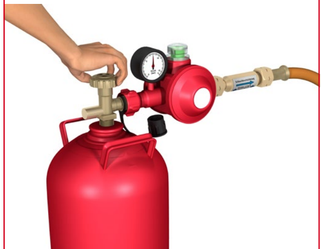
Abb. 30 Zudrehen des Flaschenventils (Flaschenventil = Hauptabsperreinrichtung, Drehrichtung rechts)
